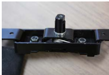
小さなスペースにバネ、ストッパー、回転軸が納められている
