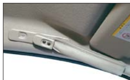
乗降の際、グリップはバネによって自動的に格納される
