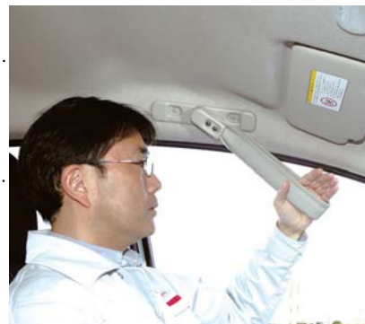
握力がなくても、手をグリップに差し込むだけで、体を支えられる
