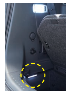
ラゲッジアンダーボックスに、室内灯を自身で設置したほか、他の室内灯やバックランプ、車幅灯などをLEDに取り替えた
