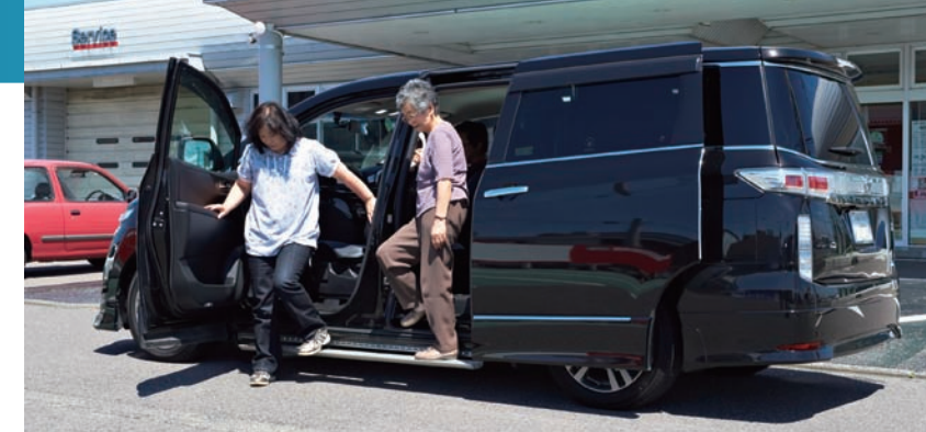
ロングステップは、助手席とスライドドアで同時に使用できる。標準装備のアシストグリップと併用で、乗降もラクラク
