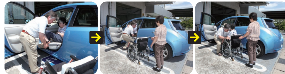
回転シートのストラップを軽く引っ張り、シートを回転させ、初枝さんを車いすに移乗させる。シートは標準車のデザイン・シート地を生かしているため、高い質感を保っている。
